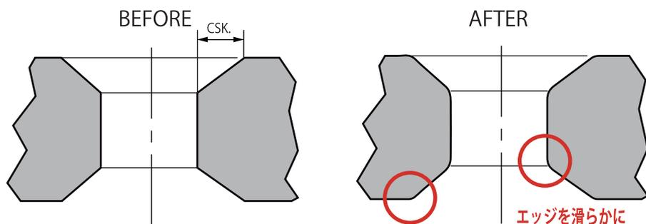
適用穴径と面取り幅に合わせて型式を選んでください。フレックスホーンの砥粒部外径は、最適なエッジ研削を行うため、穴径に対して若干オーバーサイズになっています。もし中間の穴径で、選定に迷った場合は、上のサイズを選択してください。砥粒はSC(シリコンカーバイド) 砥粒度 #180 です。Countersink size (略CSK.)
